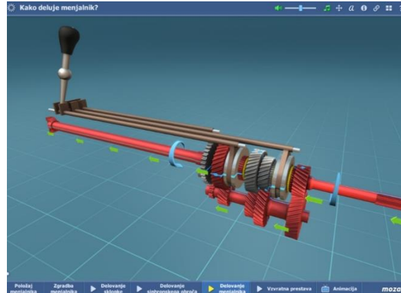
Slika 3: Zaslonski posnetek animacije delovanja menjalnika
