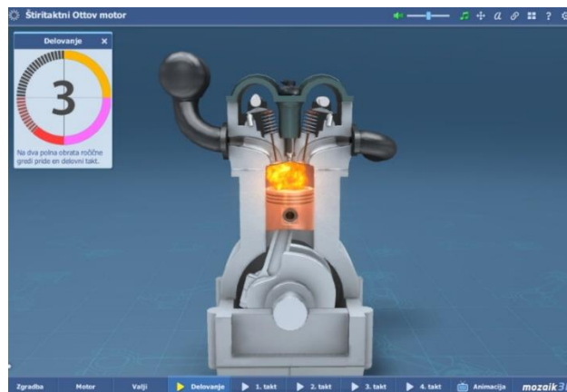
Slika 2: Zaslonski posnetek animacije delovanja 4-taktnega Ottovega motorja
